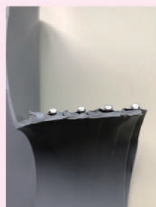
溶着後 (溶着部カット断面)
