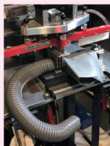
金型を挟み 溶着中(表面反対)
